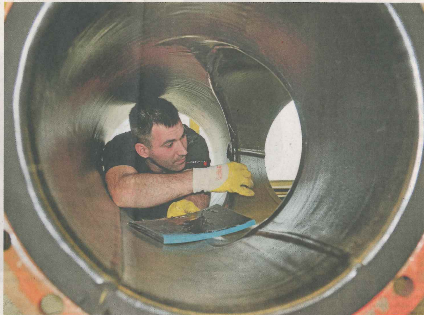
Christian Haar, dritter Bundessieger bei den Mechanikern für Reifen- und Vulkanisierertechnik, überprüft die Gummierung eines Rohres für Seewasserkühlung einschließlich der Nahtstellen.
